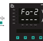
แสดงค่า Previous Fault Output 2
