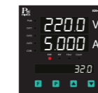
แสดงค่า Volt, Current, kWh
