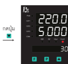
แสดงค่า Volt, Current, Digital Counter
