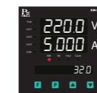
แสดงค่า Volt, Current, kWh
